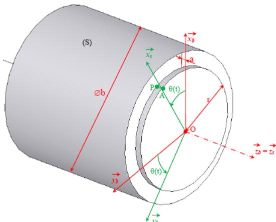
Pendant l'usinage d'un cylindre, la vitesse de rotation est assez grande pour que l'on puisse supposer que pendant un tour de mandrin, la variation des grandeurs notées  $r$  et de  $a$  sont négligeables.
